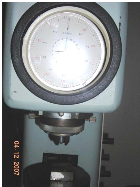
Fig.8. Aparati i Rockwellit për matjen e fortësisë
