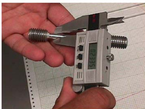
Matja e diametrit para provës dhe diametrit në vendin e këputjes
