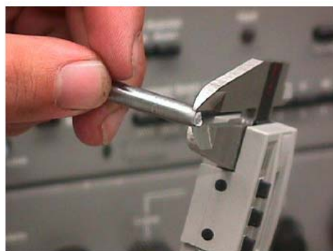
Matja e diametrit para provës dhe diametrit në vendin e këputjes
