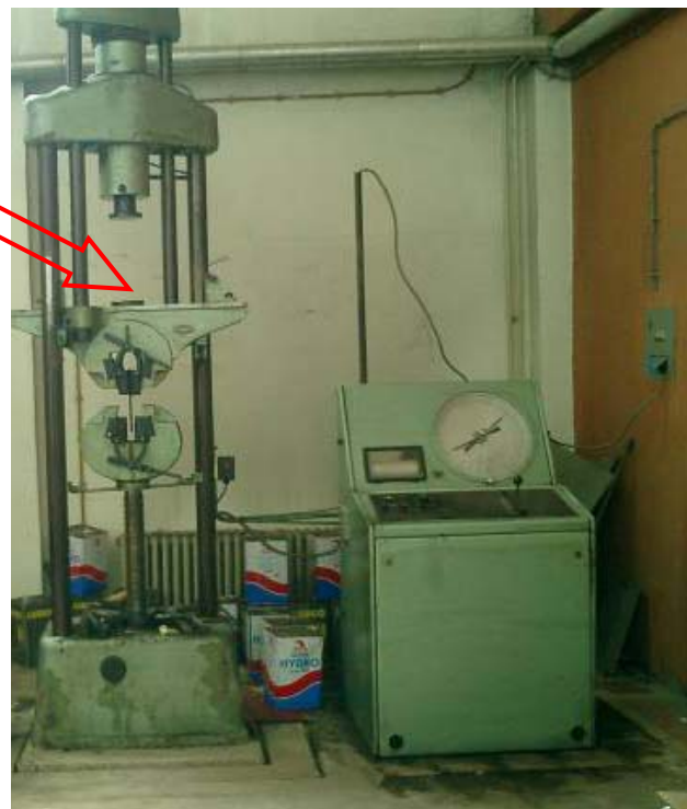
Fig.*. Makina universale për provën e shtypjes
