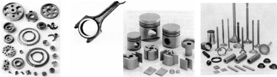
Fig.1.6. Detale të punuara nga materialet e ndryshme inxhinierike që përdoren në industrinë automobilistike
