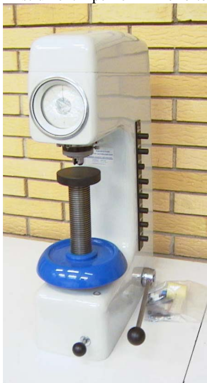
Fig.8. Aparati i Rockwellit për matjen e fortësisë
