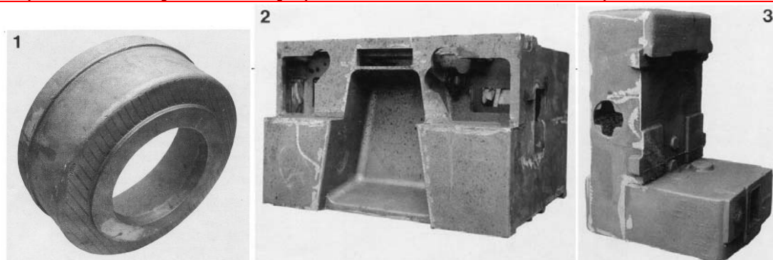
Fig.1.3. Detalet e punuara nga giza e hirtë: 1 - tamburi i frenave, 2 - bazamenti i makinës, 3 - kutia e ndërruesëve të shpejtësive
