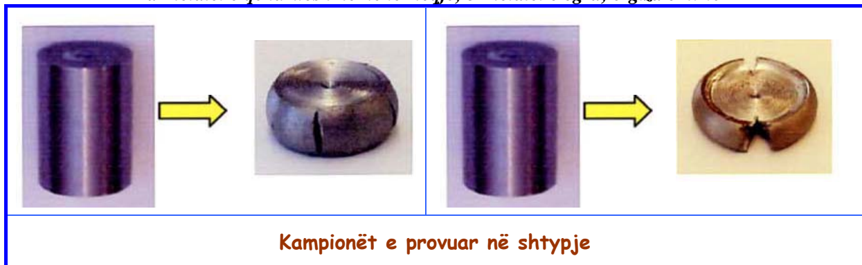
Fig.6. Plasaritjet e kampionit për shkak të shtypjes: a-metalet e qëndrueshme në tërheqje; b-metalet e egra; c-giza e hirtë
