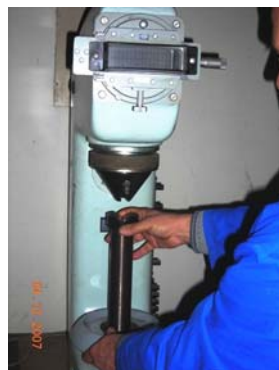
Fig. 2. Aparati për matjen e fortësisë sipas Brinellit
