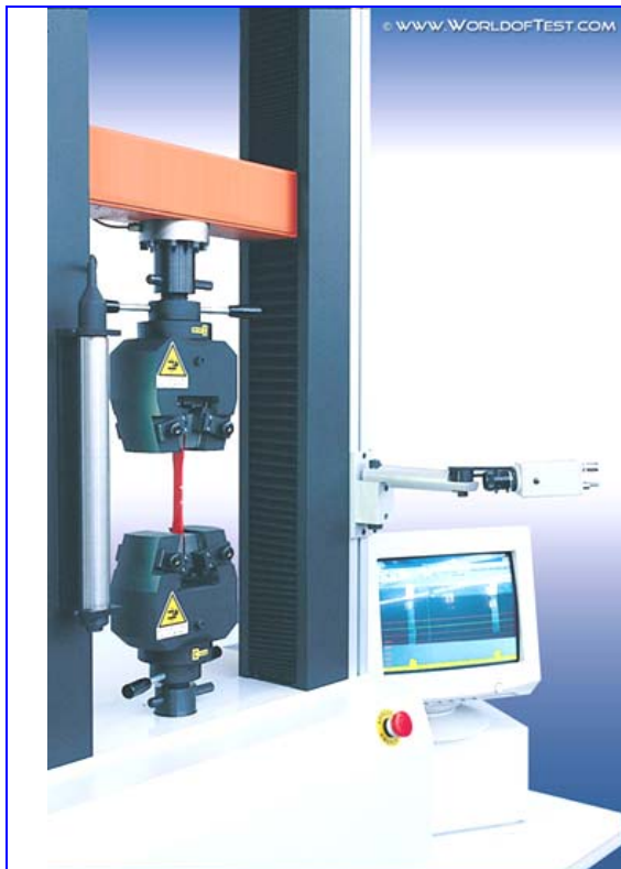
Fig.6. Makina universale për proven e tërheqjes (50 kN)
