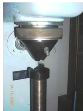
Fig. 2. Aparati për matjen e fortësisë sipas Brinellit
