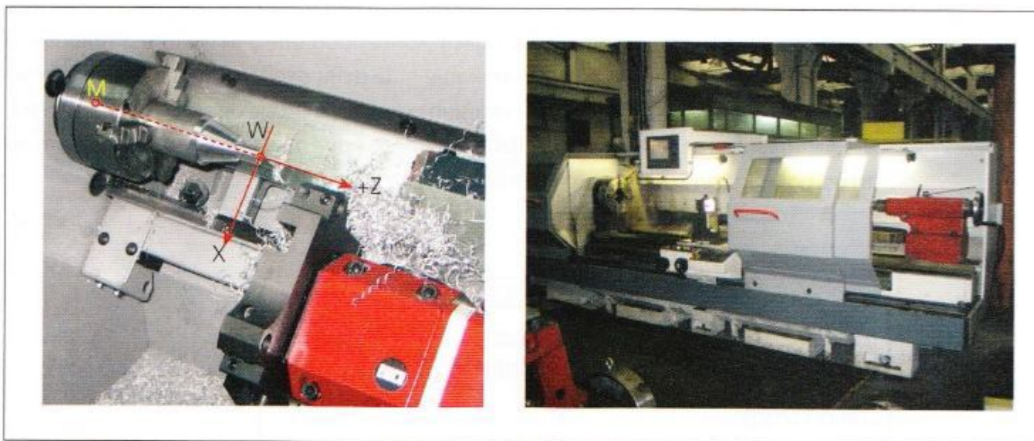
Slika 9.1. Horizontalna CNC tokarilica: a) smjer osi na školskoj tokarilici, b) industrijska
